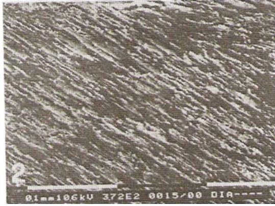
Figure 9 : Stripping avec une fraise diamantée ( \times 372 )
